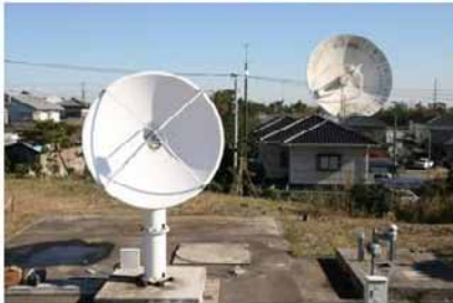
図2 2007年12月5日に実施したフリッジテストの様子。手前が新フロントエンドを搭載したCARAVAN2400、後方が34mアンテナ。
