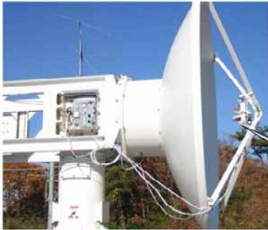
図1 新フロントエンドを搭載したCARAVAN2400。かつてサブレフがあった場所に広帯域クワッドリッジホーンアンテナ、高性能常温LNA、ダイプレクサ等を取付けている。
